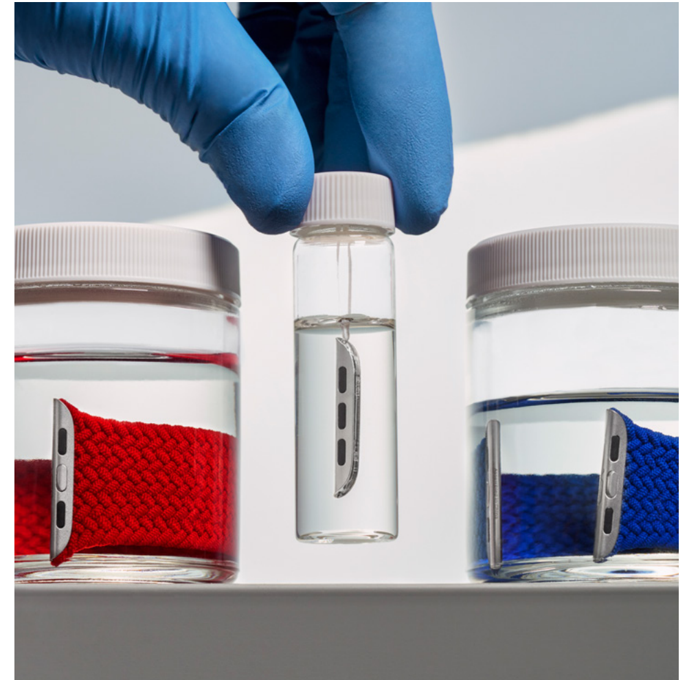
Wir testen jedes unserer Produkte und legen ein besonderes Augenmerk auf Materialien, die in längeren Kontakt mit der Haut kommen. Bei diesem Nickel-Auslaugtest geben wir Apple Watch Armbänder in Gefäße mit künstlichem Schweiß. So stellen wir sicher, dass das Nickel (ein potenzielles Allergen) dort bleibt, wo es hingehört – im Produkt.
